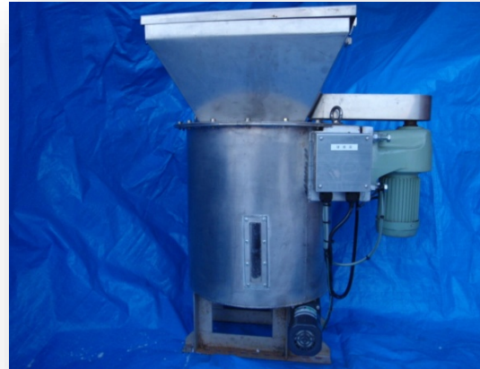
凝集剤投入機
